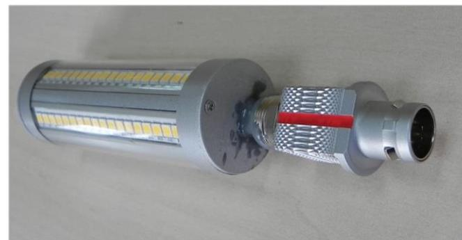
Eclairage froid LEDS, 2000 lumen, 14W équivalent 120W halogène, 220V 75mA, 3000K
