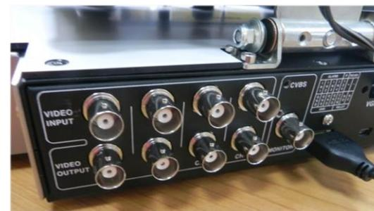
Pupitre enregistreur intégrant quadra vision avec zoom numérique, écran ATOMOS 4K enregistreur HD avec disque dur amovible de capacité 1To, permet de piloter les caméras de notre fabrication référencées CAM HD14xx , HD31xx , HD58xx et autres entrées vidéo analogiques ou HD au format TVI, CVI
