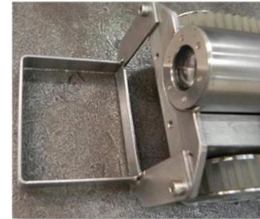
Porteur filoguidé, introduction en cellule par fourreau de diamètre 100mm,
