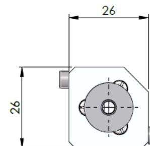
Monté dans le tube carré 30x30 support outil du bras 4 axes
